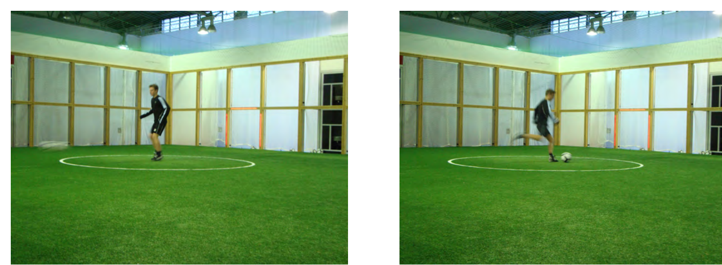
Abbildung 3: (a) Proband kurz vor der Ballannahme. (b) Proband beim Pass in das Zielfeld. Erfasst wird die Zeitdifferenz zwischen Lichtschranke Ballkanone und Lichtschranke Zielfeld.
