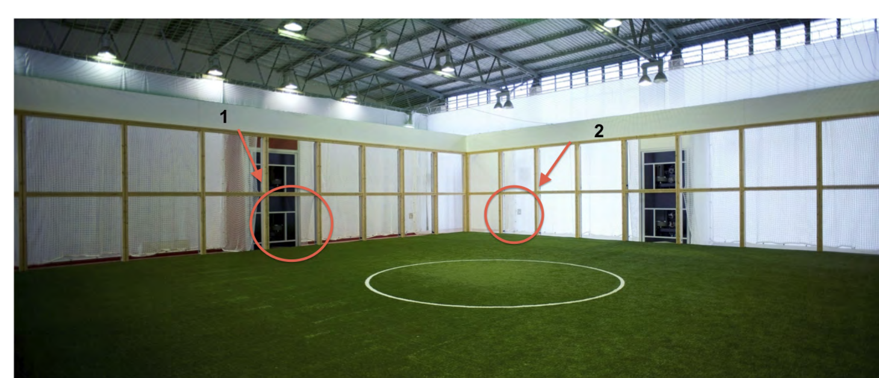
Abbildung 2: Innenansicht des Footonaut mit den Ballkanonen (1) und den Zielfeldern (2).
